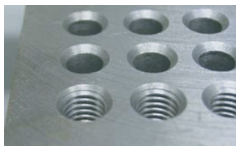
thread finishing / finitura filetto Gewindefertigbearbeitung / finissage du filet
