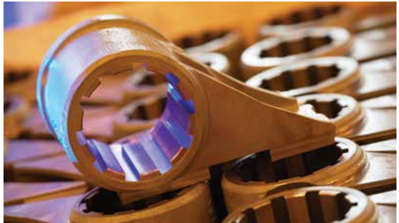
För vissa detaljer är brotschning det enda möjliga produktionssättet.
